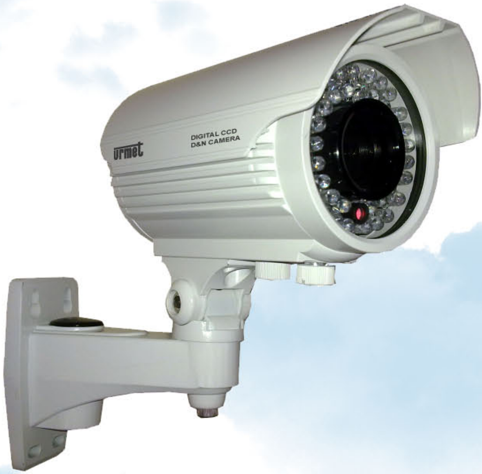
1092/204A Vodě odolná: IP66, kabel zabudován v držáku kamery IR LED pracovní dosah: 30m Objektiv: 4-9mm s manuálním zoomem
